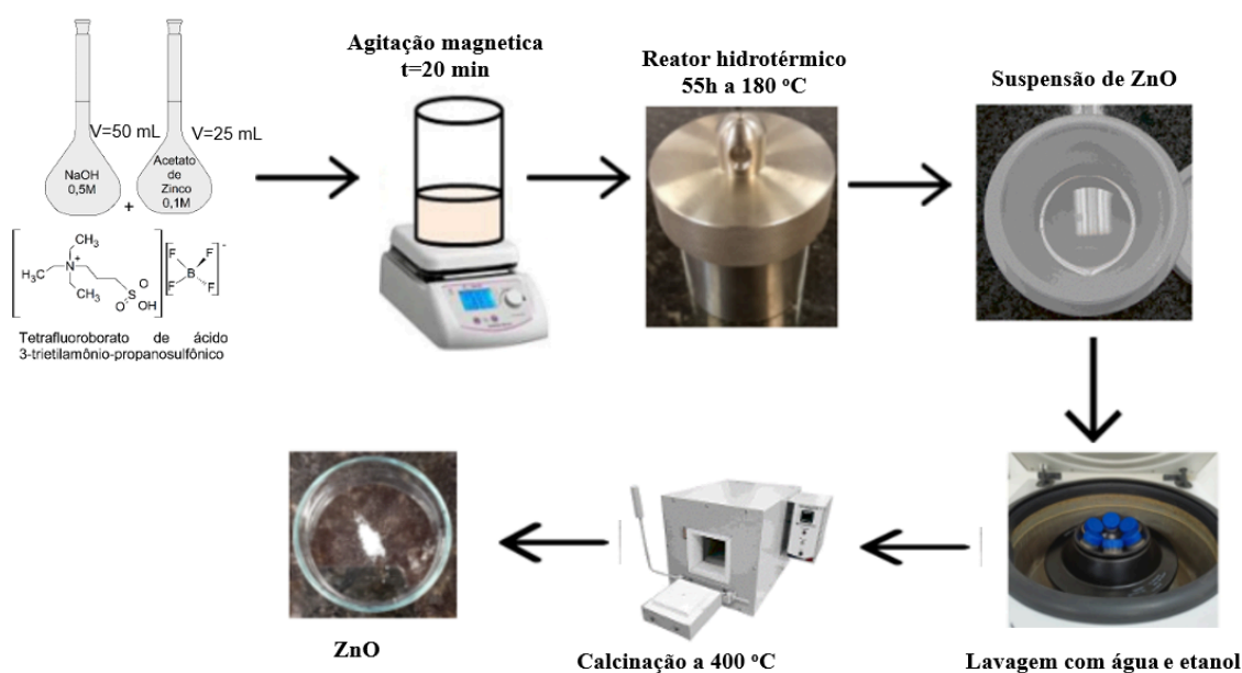
Figura 8. Representação das etapas realizadas para síntese de ZnO pelo método hidrotérmico.
