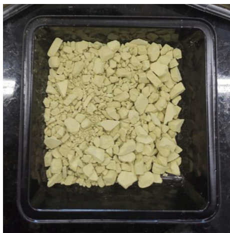
Figura 8. Catalisador 10%Cu/Nb 2 O 5 sintetizado por impregnação por via seca.
