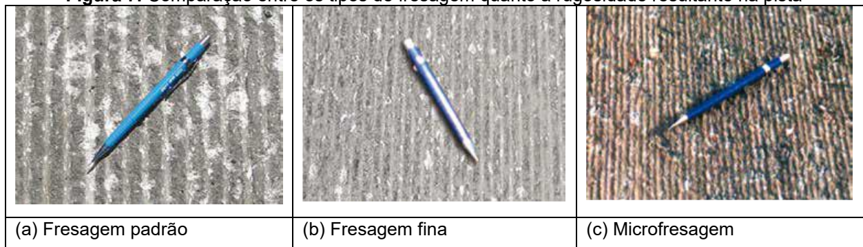
Figura 7. Comparação entre os tipos de fresagem quanto à rugosidade resultante na pista
