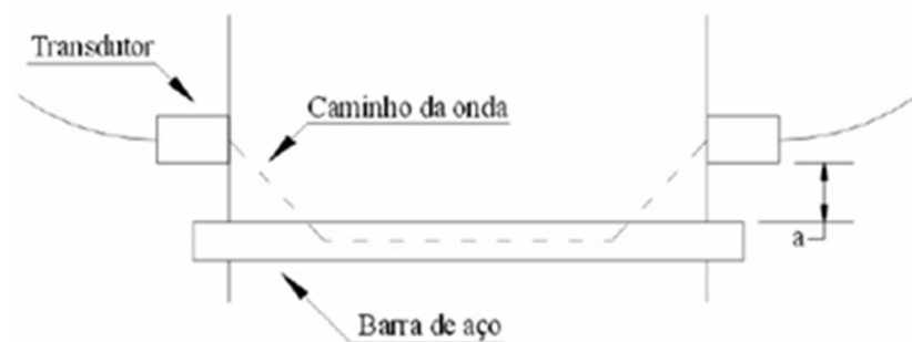
Figura 7: Barras paralelas à propagação da onda de ultrassom
