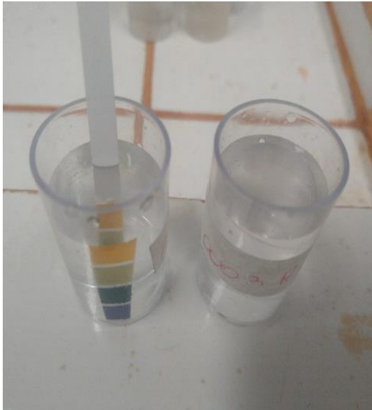
Figura 10 - Medição do PH da solução
