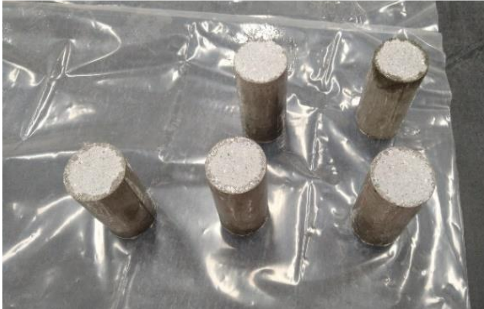
Figura 6 - Processo de resinagem dos CPs cilíndricos
