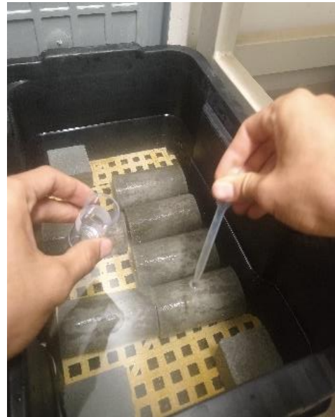
Figura 11 - Coleta das amostras de solução lixiviante
