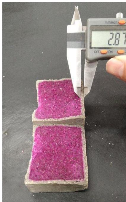
Figura 8 - Medição da área lixiviada com o auxílio de um paquímetro
