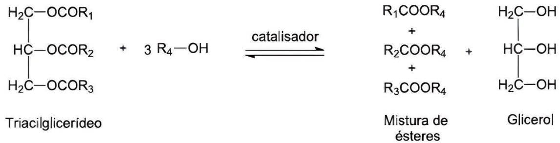
Figura 1: Reação de transesterificação para a produção de biodiesel
