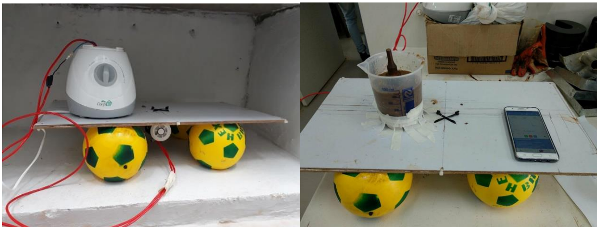
Figura 8. Mesa vibratoria y equipo en su estado final
