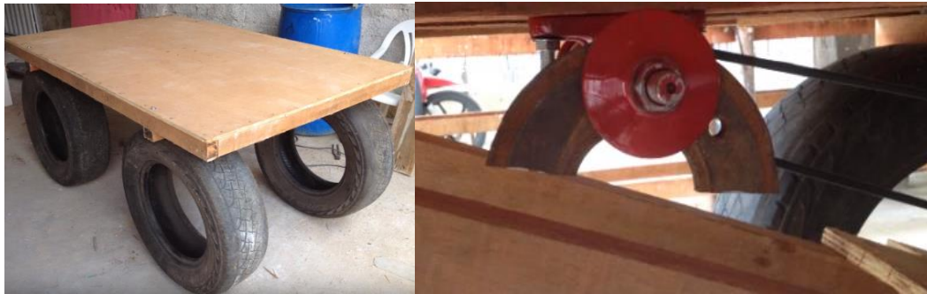
Figura 2. Mesa vibratoria casera con llantas, a) sistema de llantas-amortiguadores, b) Motor con excentricidad. (Andrade, 2016).
