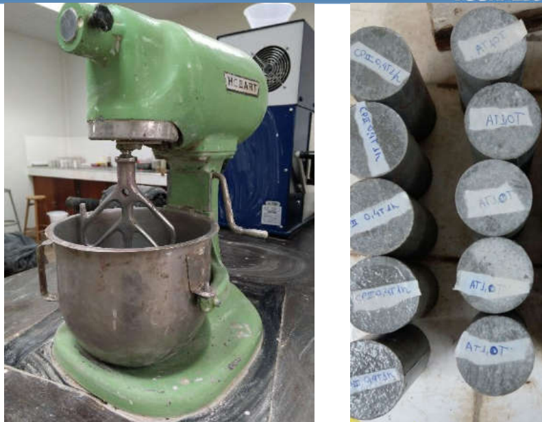
Figura 4 e 5 – Argamassadeira e corpos de prova moldados
