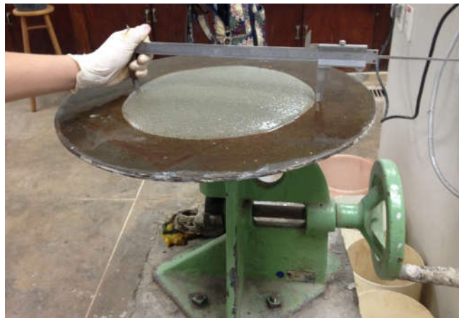
Figura 6 - Execução do Ensaio de Consistência
