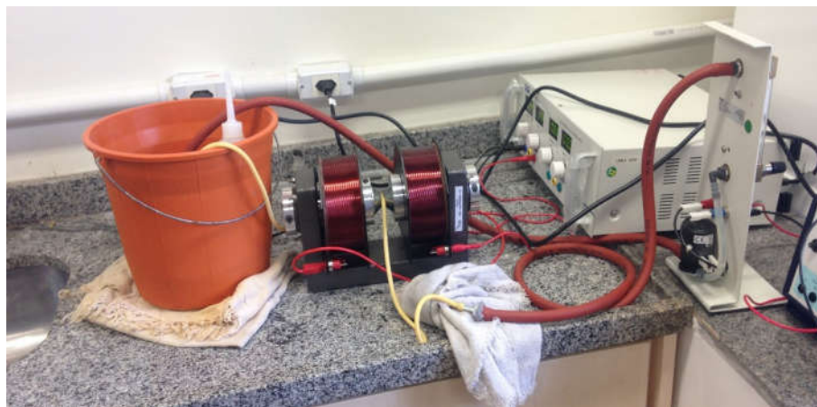
Figura 2 – Sistema de tratamento magnético da água utilizando o eletroímã.
