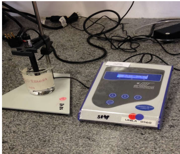
Figura 3 – Ensaio de medida do pH com pH-metro
