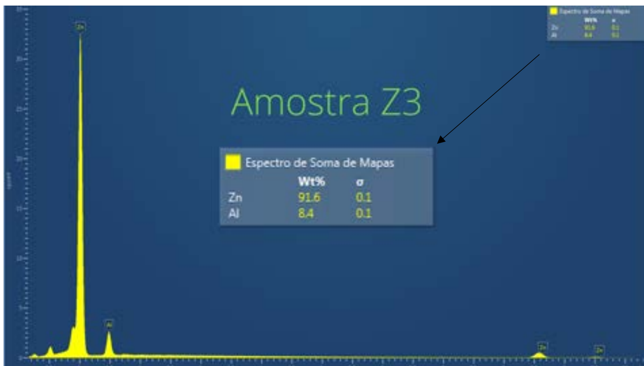
Figura 23 – Análise de EDS da amostra Z3.
