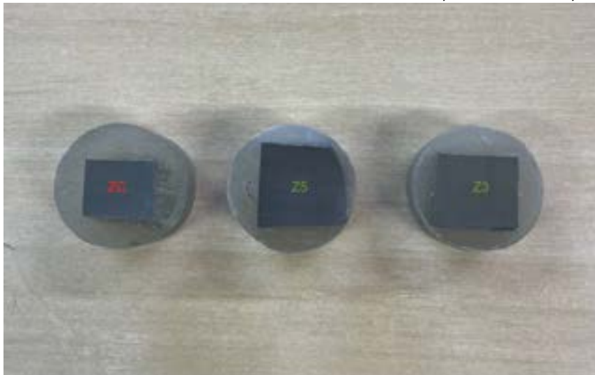
Figura 17 – Amostras embutidas na resina acrílica, amostra ZC, Z5 e Z3.
