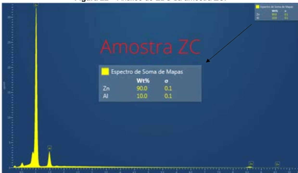
Figura 22 – Análise de EDS da amostra ZC.
