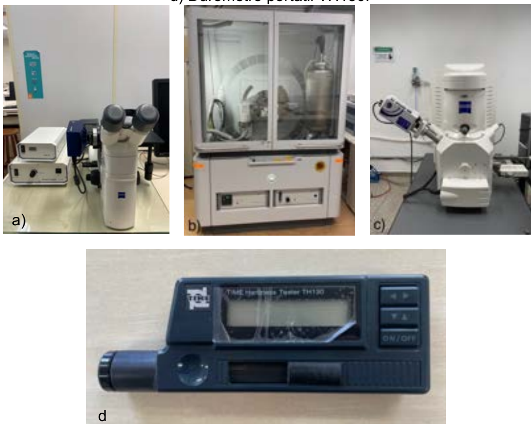
Figura 16 – Equipamentos utilizados nas caracterizações dos materiais. a) Microscópio óptico ZEISS, b) DRX PANalytical, c) MEV acoplado com EDS ZEISS, d) Durômetro portátil TH130.
