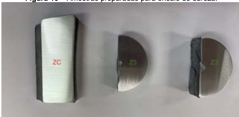
Figura 18 – Amostras preparadas para ensaio de dureza.
