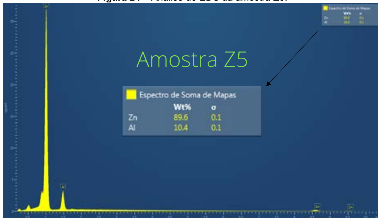
Figura 24 – Análise de EDS da amostra Z5.
