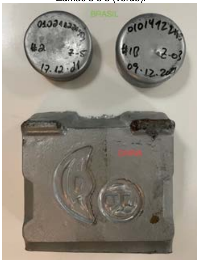
Figura 15 – Materiais de partida, ligas de zinco chinesa (vermelho), brasileiras Zamac 3 e 5 (verde).
