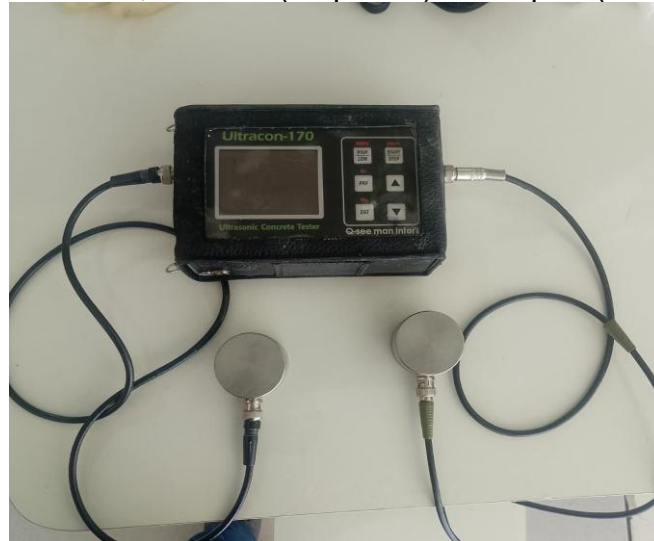
Figura 24 – Instrumento de Medidor de Pulso Ultrassônico (UPV) com seus transdutores, emissor (esquerda) e receptor (direita).
