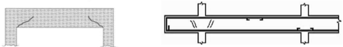
Figura 11 – Fissura por cisalhamento.
