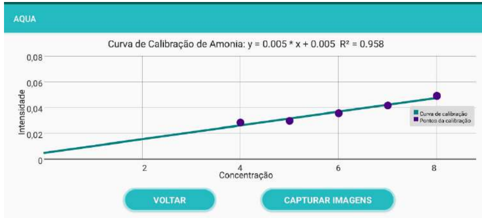
Figura 16 - Curva analítica da amônia para uso in loco utilizando o aplicativo AQUA
