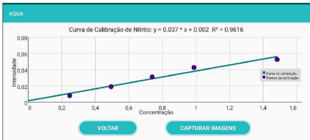
Figura 14 - Curva analítica do nitrito para uso in loco utilizando o aplicativo AQUA
