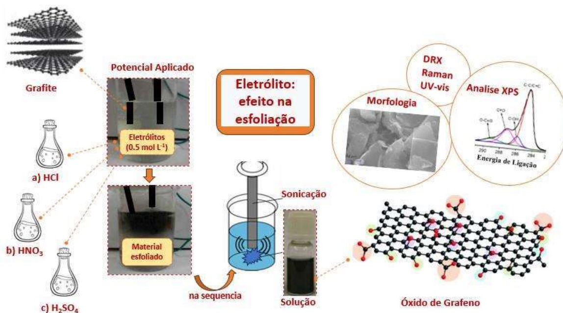
Figura 19. Etapas da síntese de óxido de grafeno (GO) por esfoliação eletroquímica de grafite de pilhas descarregadas pelo uso de eletrólitos ácidos. Fonte: Autor.
