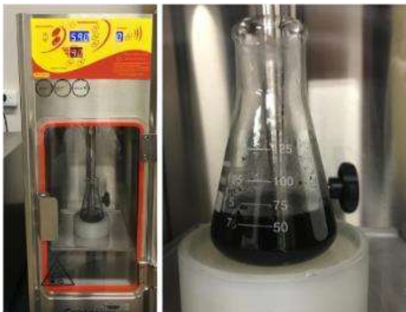
Figura 22. Processo de ultrasonicação (ponteira ultrassônica). Fonte: Autor.
