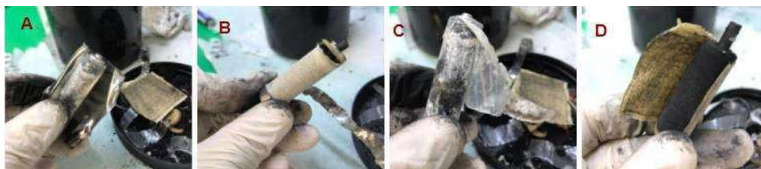
Figura 20. (A-D) Sequência de desmontagem das pilhas para a remoção do eletrodo de grafite. Fonte: Autor.
