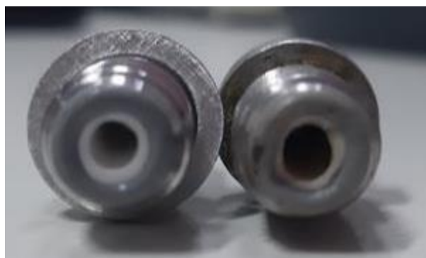
Figura 17 - Exemplo de um bico de centrífuga novo (à esquerda) e um bico desgastado (à direita)
