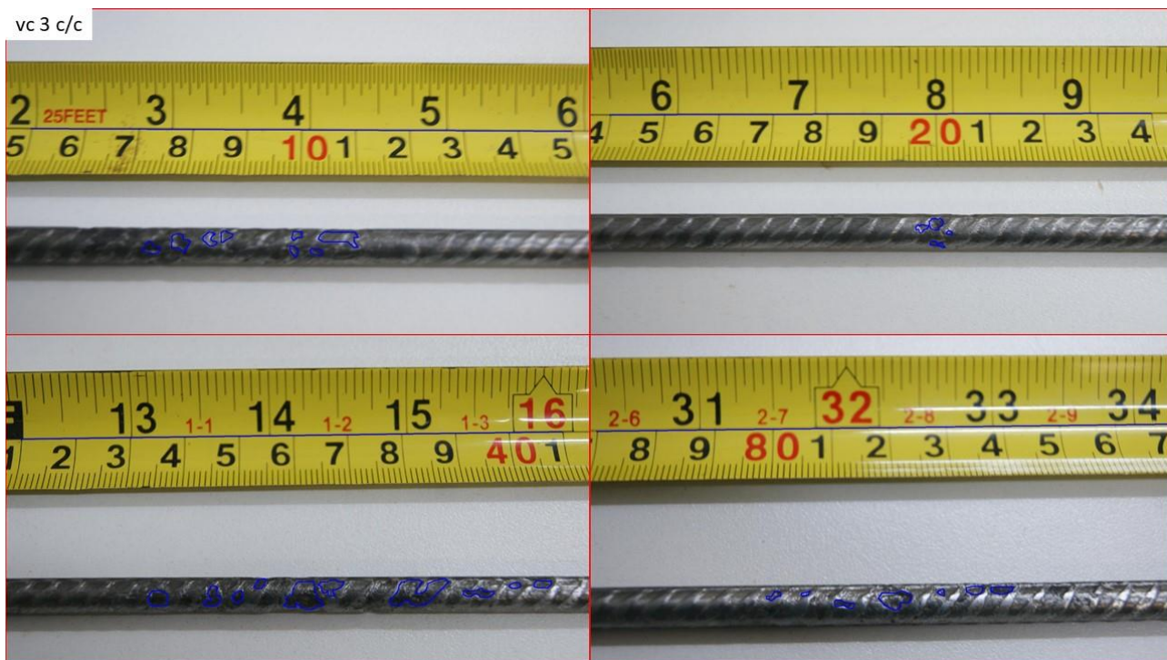
Figura 94 - áreas superficiais corroídas do vergalhão da viga vc 3 c/c – parte 1
