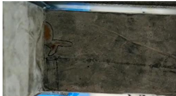
Figura 53 - ponto de ferrugem na vc 3 c/c na junta do console, aos 140 dias de idade
