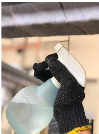
Figura 38 – Aspersão de solução de NaCl a 3,5% na viga enrolada com membrana geotêxtil.
