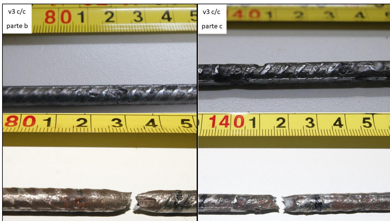
Figura 99 - Pontos dos pites e de ruptura no ensaio de tração das barras da viga vc 3 c/c
