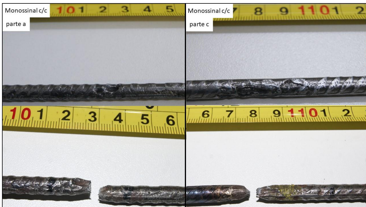
Figura 96 – Pontos dos pites e de ruptura no ensaio de tração das barras da viga monossinal c/c
