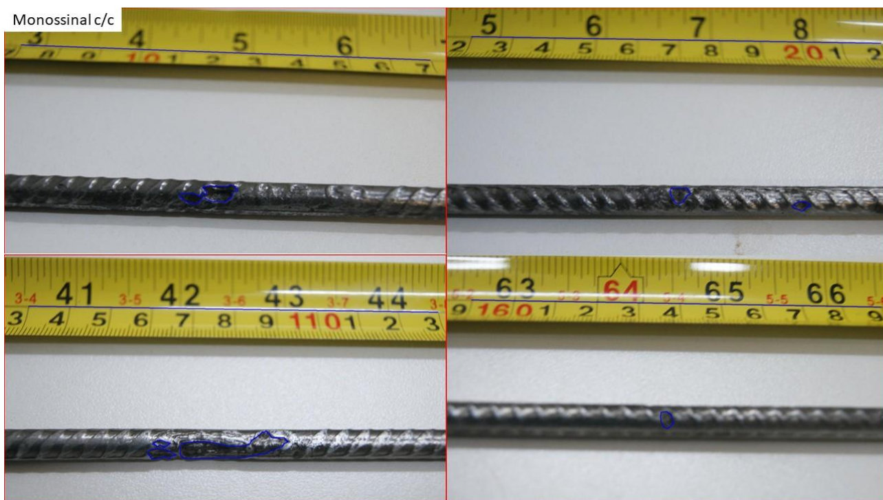
Figura 88 - áreas superficiais corroídas do vergalhão da viga monossinal c/c – parte 1
