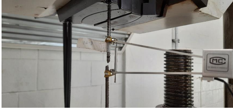
Figura 50 – Barra rompida após o ensaio de tração.
