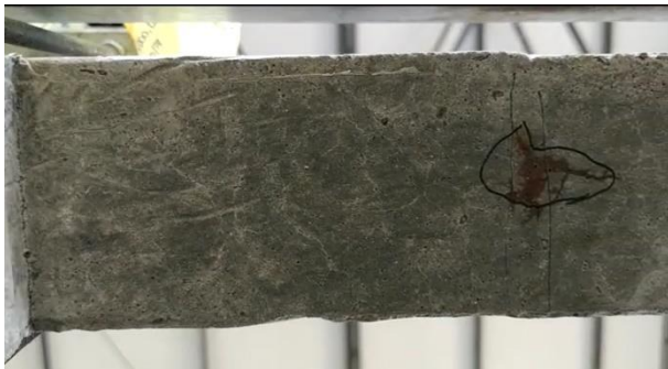
Figura 52 – ponto de ferrugem na vc 2 c/c próxima ao console, aos 140 dias de idade
