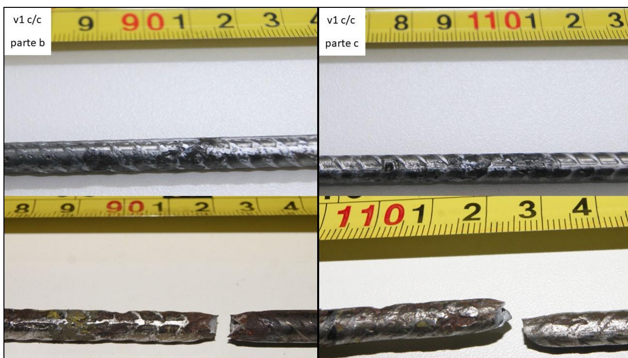
Figura 97 - Pontos dos pites e de ruptura no ensaio de tração das barras da viga vc 1 c/c
