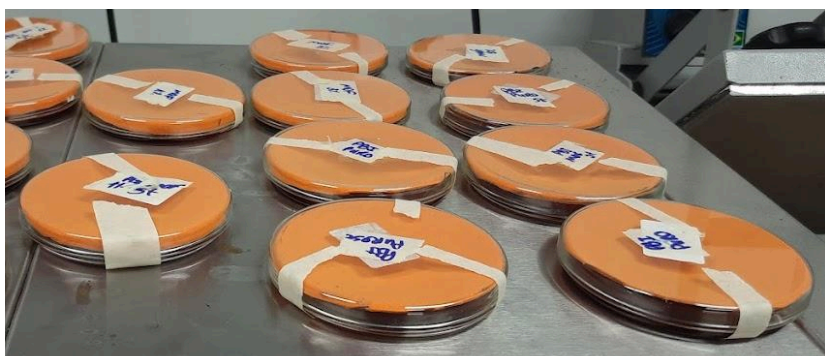
Figura 11 - Imagem ilustrativa das membranas produzidas com copoli (estireno divinil-benzeno) durante a secagem.
