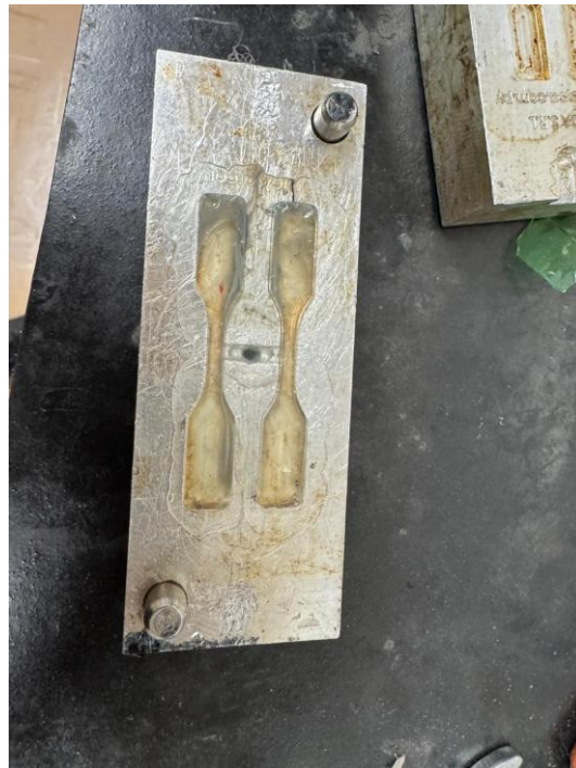
Figura 17 – Molde com amostra recém produzida.
