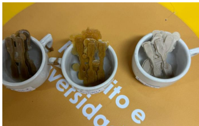
Figura 18: Corpos de prova tipo “halteres”
