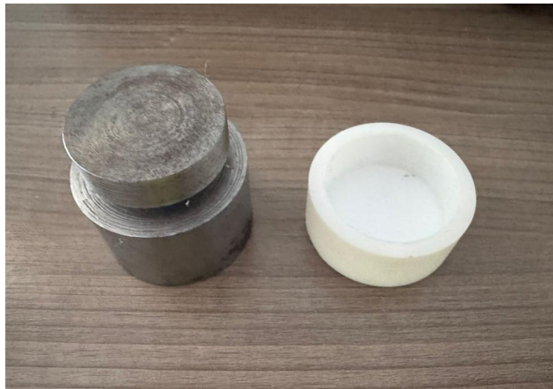
Figura 19 – Molde para produzir disco como corpo de prova.
