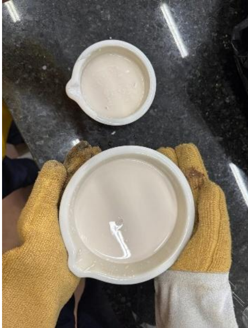
Figura 7: Mistura de casca de ostra com água após moagem
