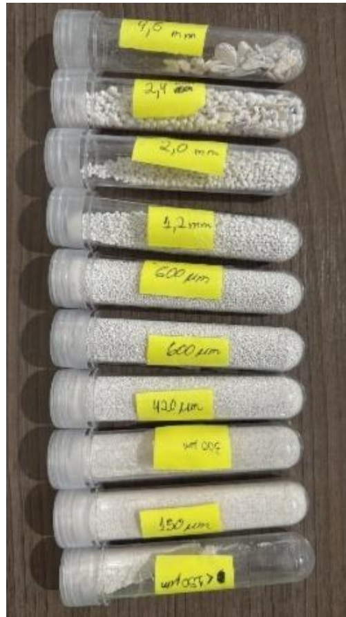
Figura 12: Amostras separadas por granulometria.
