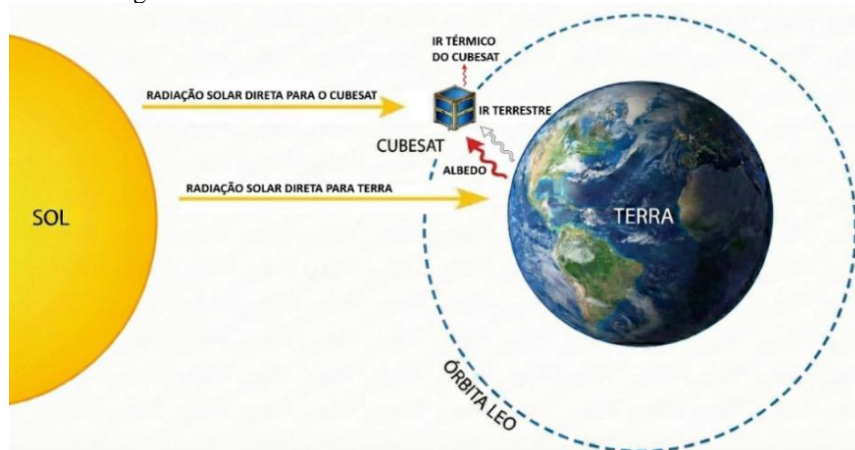
Figura 2- Fontes de fluxo térmico externo em órbita terrestre.
