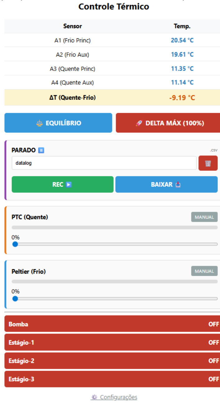
Figura 18-Interface principal de controle térmico e monitoramento em tempo real da bancada experimental.
