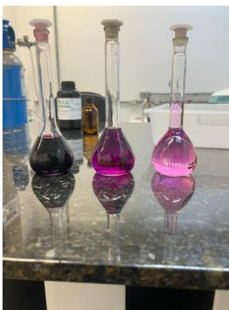
Figura 3 – Diluição de \text{KMnO}_4 para a obtenção da solução de trabalho.
