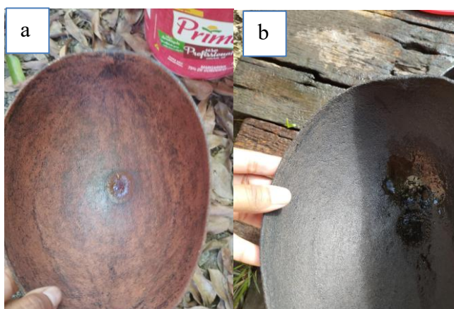
Figura 11a-11b- Reação do cumatê antes e depois da exposição com vapor amoniacal: (a) Cuia só com cumatê ; (b) Cuia depois da exposição ao vapor amoniacal
