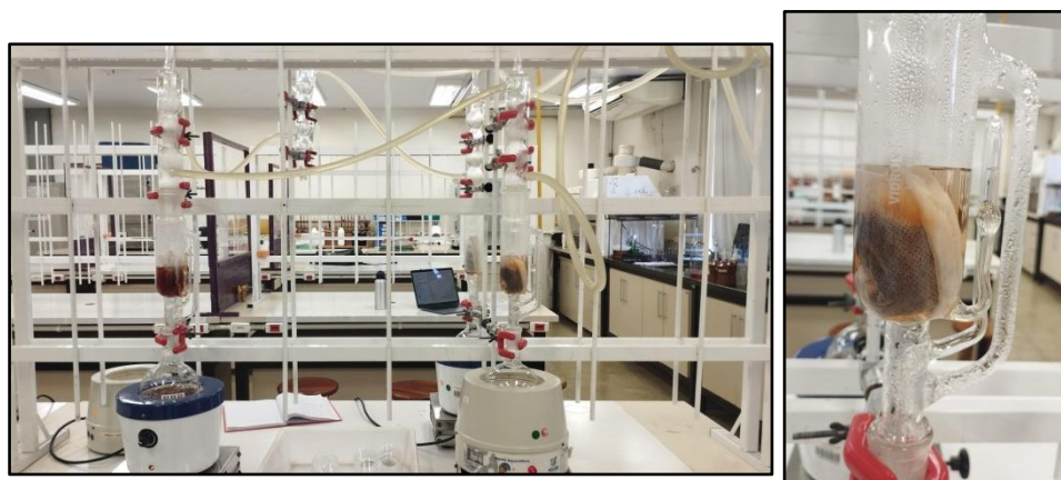
Figura 3- Extrator Soxhlet com manta aquecedora ligada em série; com a amostra posicionada
