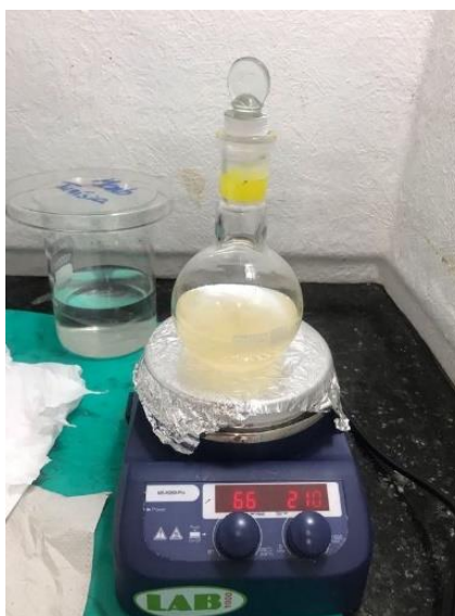
Figura 12 – Reação do TEA-PS com HBF 4 em agitação magnética
