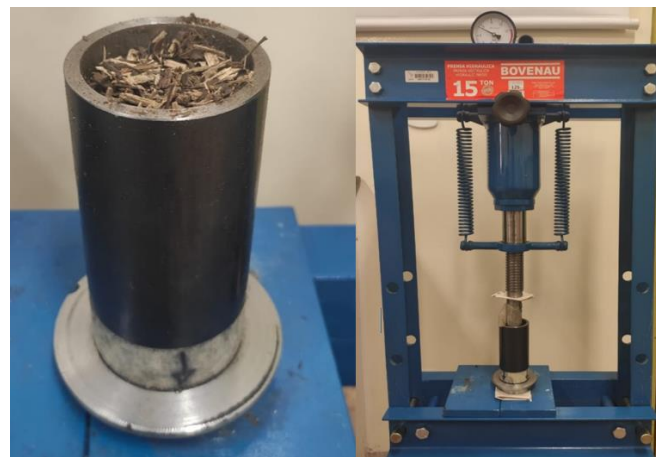
Figura 3.5 - a) Conteúdo de RPA colocado no cilindro, antes da compactação; b) Arranjo final da prensa e briquetadeira durante a briquetagem.
