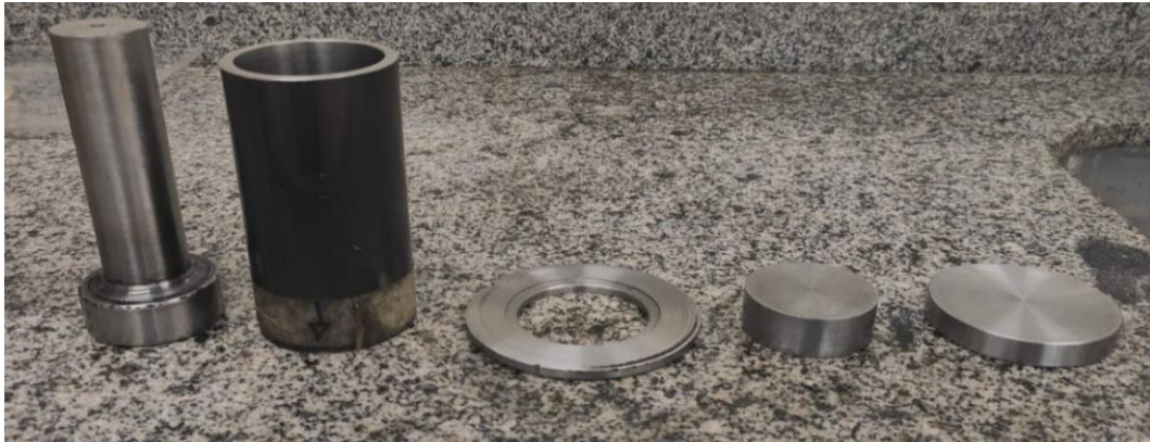
Figura 3.4 - Briquetadeira utilizada para compactação das amostras de RPA e de Erva Mate.
