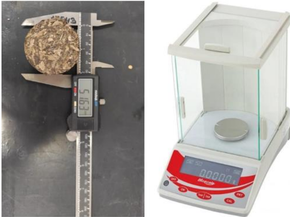
Figura 3.7 - Equipamentos utilizados para obtenção da densidade aparente dos briquetes de RPA e de Erva Mate.
