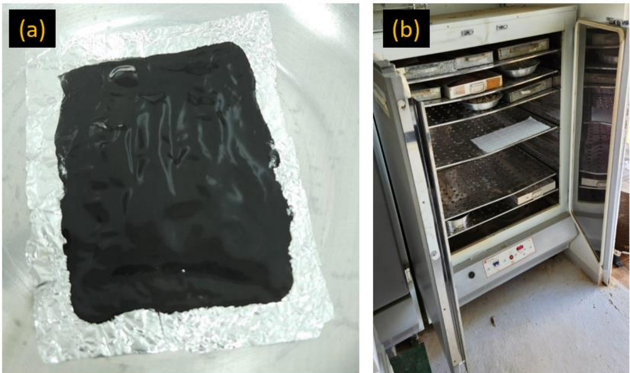
Figura 7 – (a) Amostra de pó compósito disposta em lâmina metálica para secagem. (b) – Estufa de secagem.
