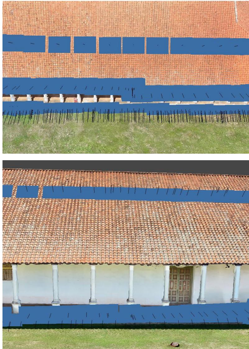
Figura 38. Posición de la cámara del dron para la obtención de imágenes.
