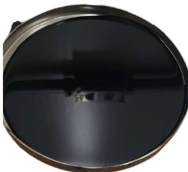
Figura 14: Recipiente contendo o Ligante Asfáltico (CAP 50/70) utilizado na pesquisa
