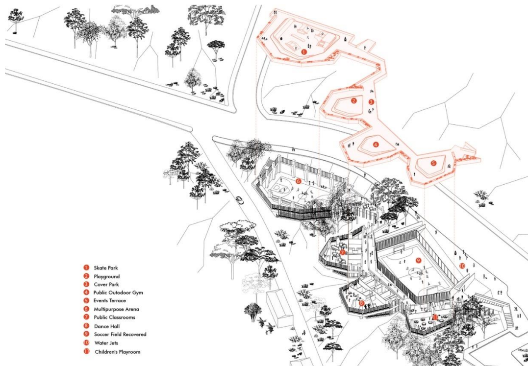
Figura 46 -Planta axonométrica del centro comunitario con sectorización de cada espacio.
