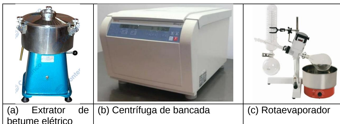
Figura 2. Equipamentos utilizados para obtenção do CAP envelhecido
