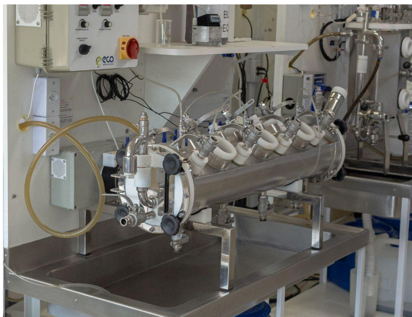
Figura 2 - Biorreator de Lagoa Coberta (BLC). Fonte: Cibiogás, Itaipu Parquetec 2024 - Foz do Iguaçu, PR
