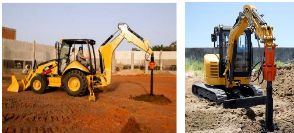
Figura 23: Perfuratriz hidráulica HB-17.
