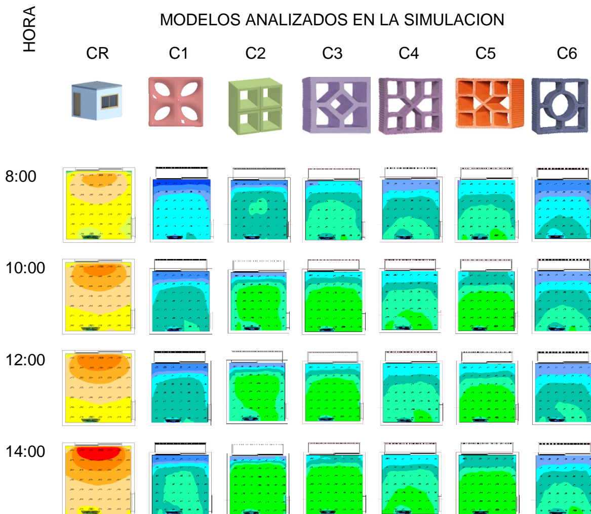
Figura 42- Resultado de simulación por medio de colores falsas orientación oeste.
