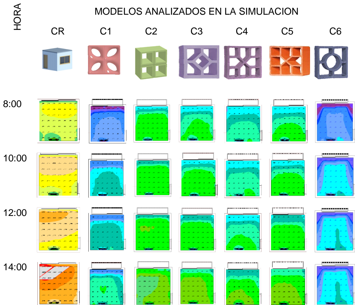
Figura 230- Resultado de simulación por medio de colores falsas orientación oeste.
