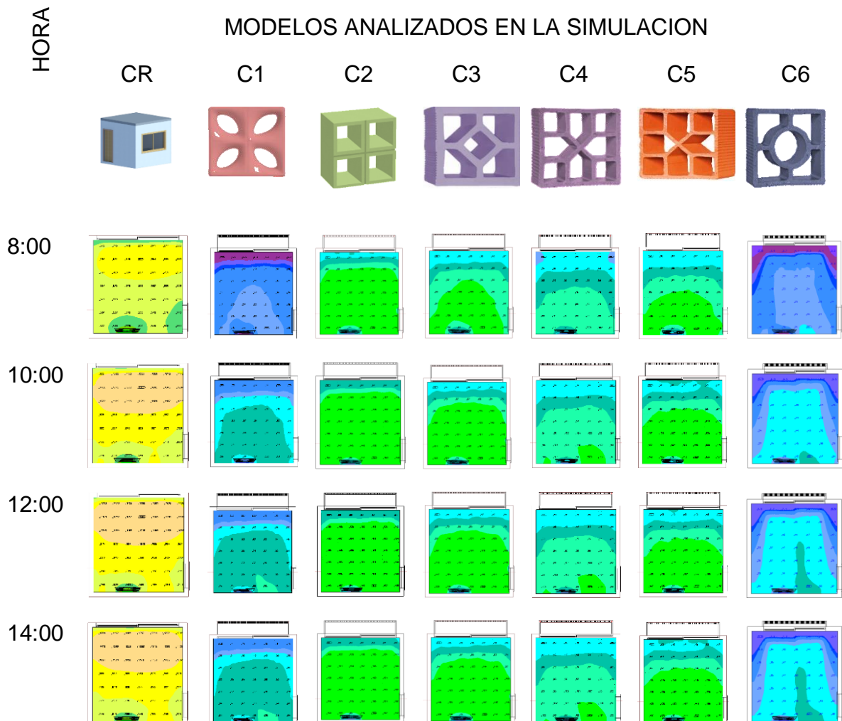
Figura 206- Resultado de simulación por medio de colores falsas orientación sur.
