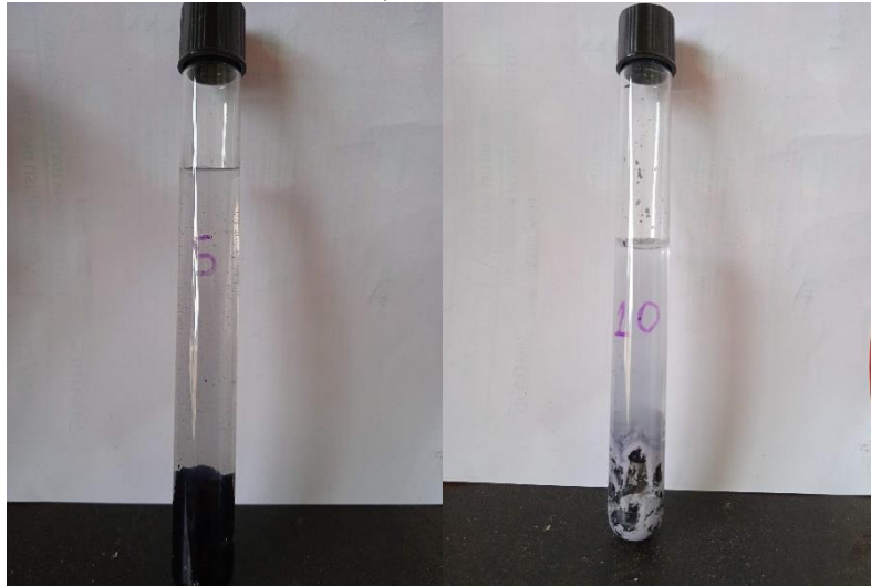
Figura 15 - Tubos de ensaio com Pani (HCl) e \text{AgNO}_3 , na esquerda concentração 0,001 \text{ mol L}^{-1} e na direita 0,1 \text{ mol L}^{-1} .
