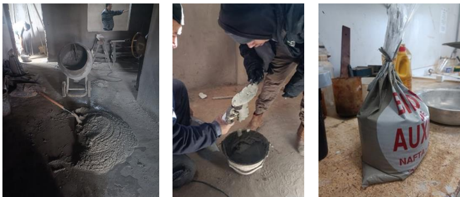
Figura 8: Processo de coleta e ensacado da argamassa fresca
