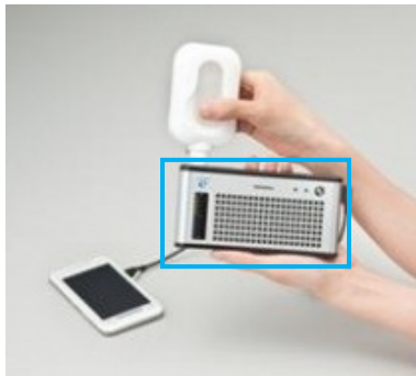
Célula de metanol para alimentar aparelhos portáteis
