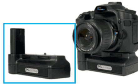
Protótipo de célula a combustível para alimentar câmeras fotográficas SLR com o dobro da autonomia das baterias tradicionais
