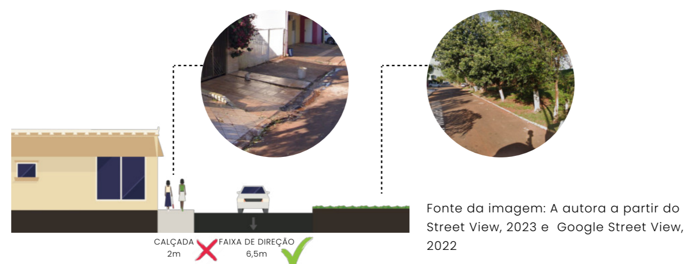
Figura 137- Esquema da Via Local de acordo com a legislação
