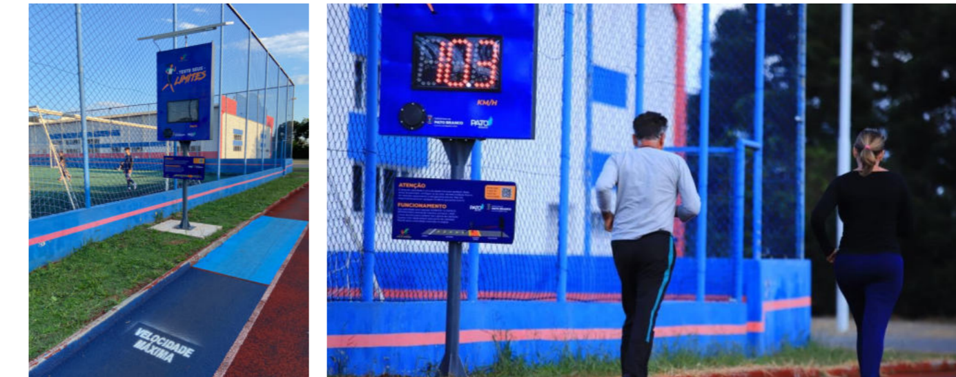
Figuras 51 e 52 - Painel digital medidor de velocidade
