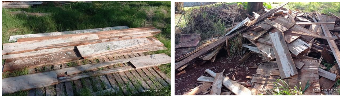
Figura 20 – Madeira serrada na obra 12C: a) material sem desmoldante; b) peças quebradas e danificadas pela ação da umidade
