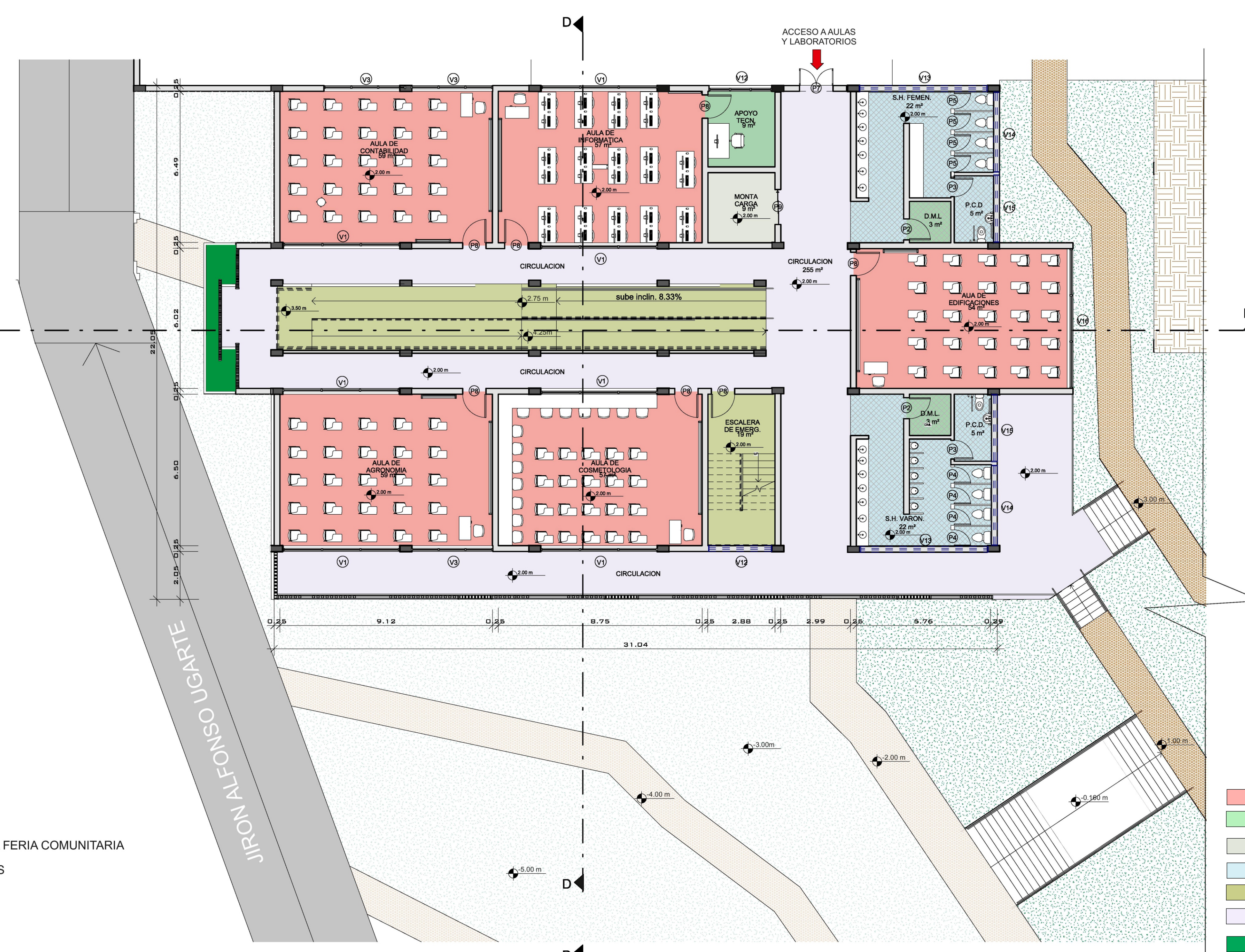
2 PLANTA BAJA NIVEL 2 - NIVEL 5 ESCUELA TECNICA ESC. 1:100
