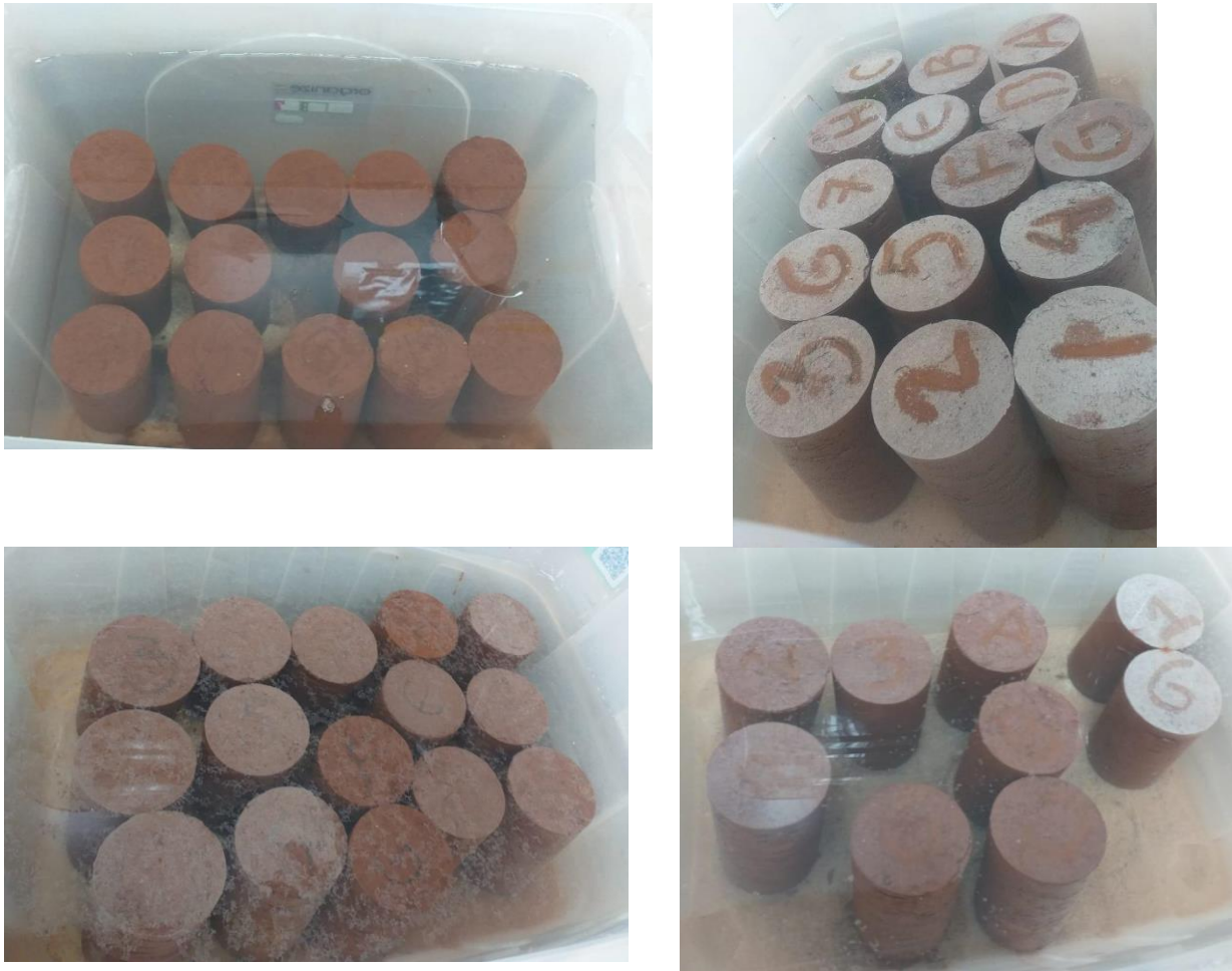
Figura 21 – Corpos de prova com 6, 9 e 12% de solo – Cimento compactado processo de cura
