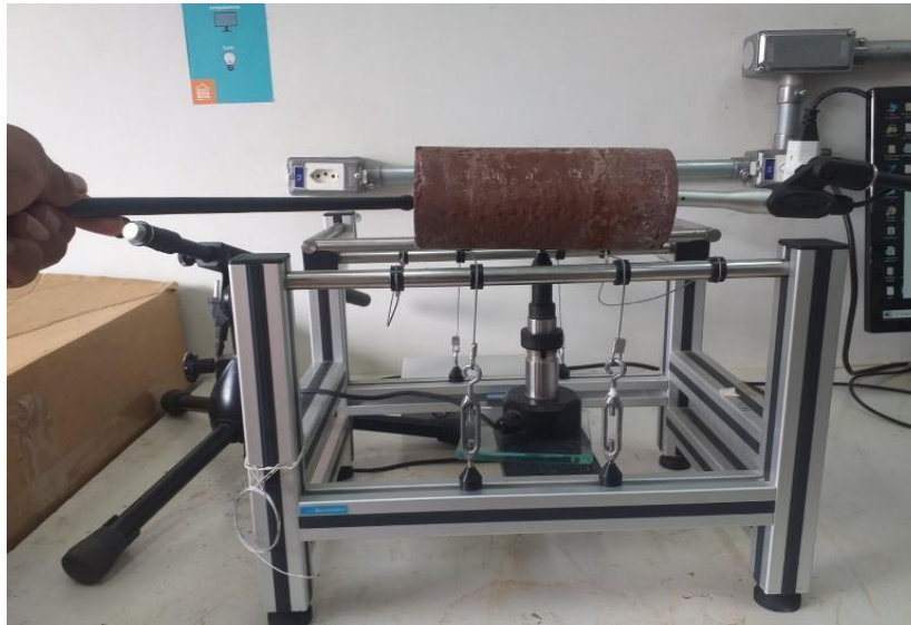
Figura 23 – Ensaio do módulo de elasticidade dinâmico pela Técnica de Excitação por impulso
