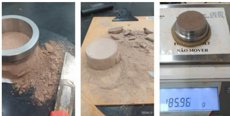
Figura 26 – procedimiento de remoldado de material
