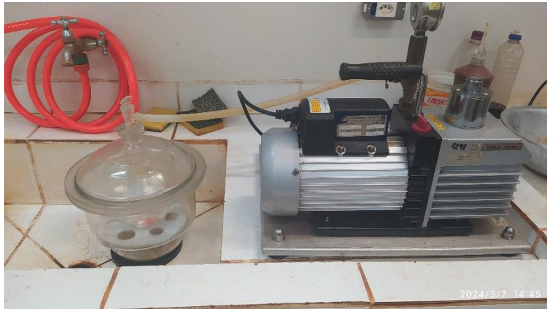
Figura 18 – Ensayo de masa específica de los sólidos con bomba de vacío
