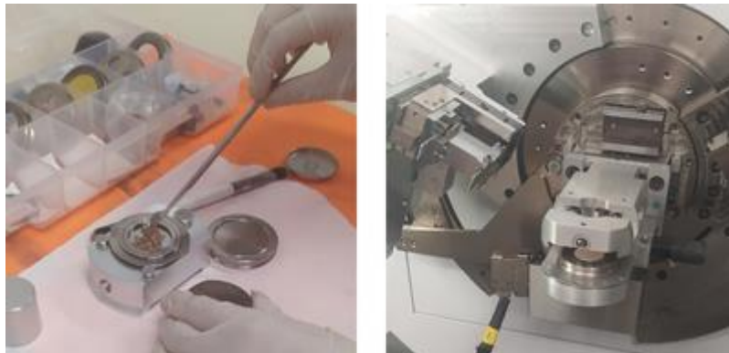
Figura 21 – Procedimiento de preparación y ensayo de rayos x
