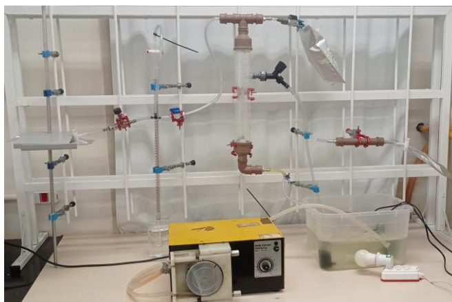
Figura 21 - Sistema de tratamento de biogás construído.
