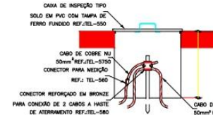
DETALHE DE INSTALAÇÃO DE CAIXA DE INSPAÇÃO TIPO SOLO COM CONECTOR DE MEDIÇÃO
