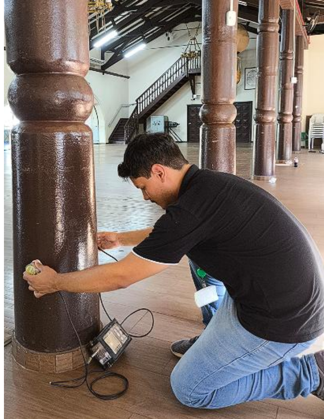
Figura 50: Aplicação do Ensaio De Ultrassom
