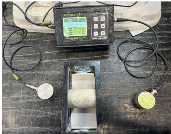
Figura 14: Utilização do Equipamento Ultrassom
