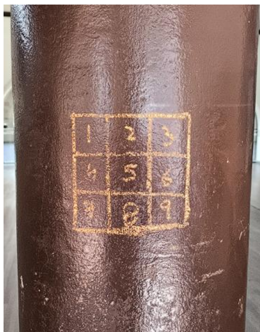
a) Grid De aplicação Esclerométrico: (12x12) cm
