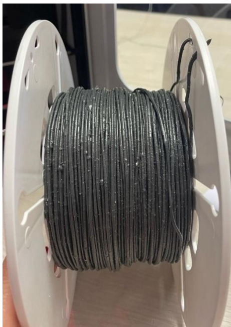
Figura 24 – Filamento Compósito de HAp/PLA dopado com \text{AgVO}_3 fabricado via extrusão.
