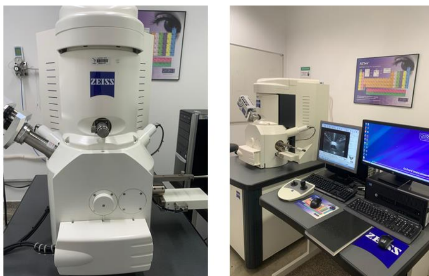
Figura 12 - Equipamento utilizado EVO MA 10 (ZEISS, Alemanha) para análise elementar, morfológica e microestrutural das amostras obtidas.
