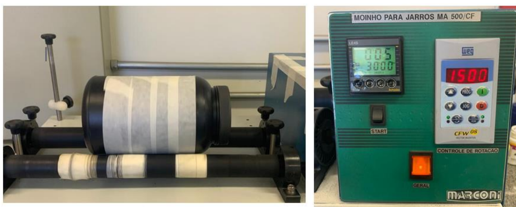
Figura 11 – Moinho de jarros utilizado no processo de moagem das amostras calcinadas a 1140°C e 800°C.
