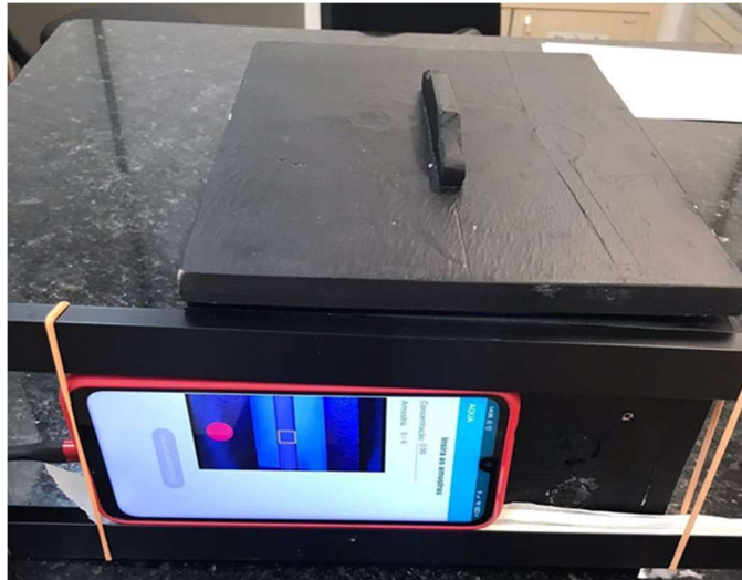
Figura 3-9S – Caixa de aquisição de imagens e aplicativo de celular utilizado para análise colorimétrica
