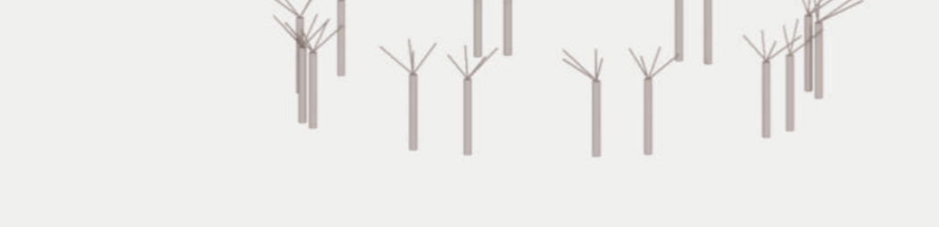
Pilares metálicos redondos (45) com rótula que conectam as hastes, e se ligam aos nós da treliça espacial
