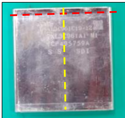
Figura 12: Cortes Realizados Durante a Abertura Mecânica de uma LIB.
