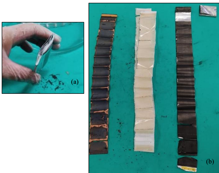
Figura 25: (a) Estrutura em Jelly Roll de uma LIB; (b) Componentes Internos: Ânodo, Separador e Cátodo (da Esquerda para a Direita).
