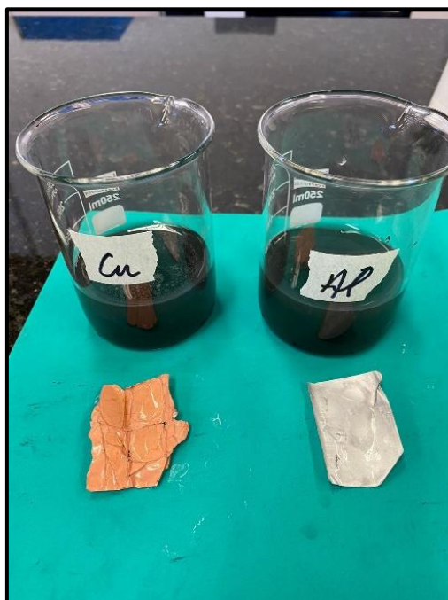
Figura 27: Resultado da Separação do Material Ativo dos Coletores de Corrente de Cu e Al.
