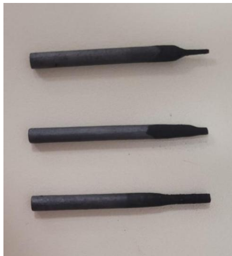
Figura 19- Hastes de grafite após a esfoliação.
