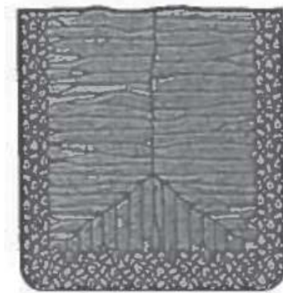
Figura 5- Estrutura de grãos de um metal fundido.
