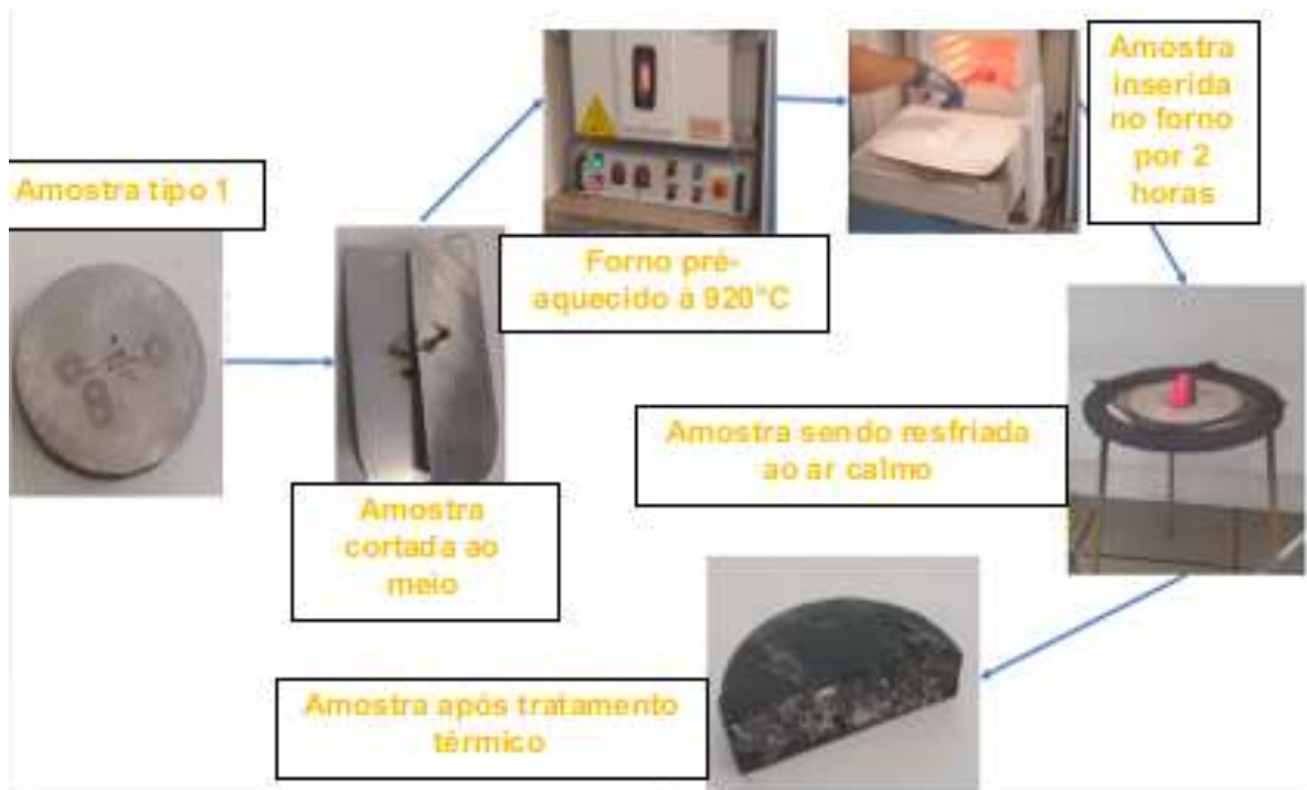
Figura 26 - Fluxograma do tratamento de normalização
