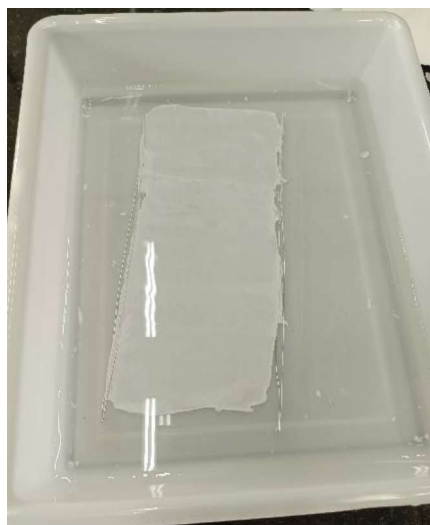
Figura 12 – Placa de vidro imersa em banho de água na etapa de coagulação da membrana
