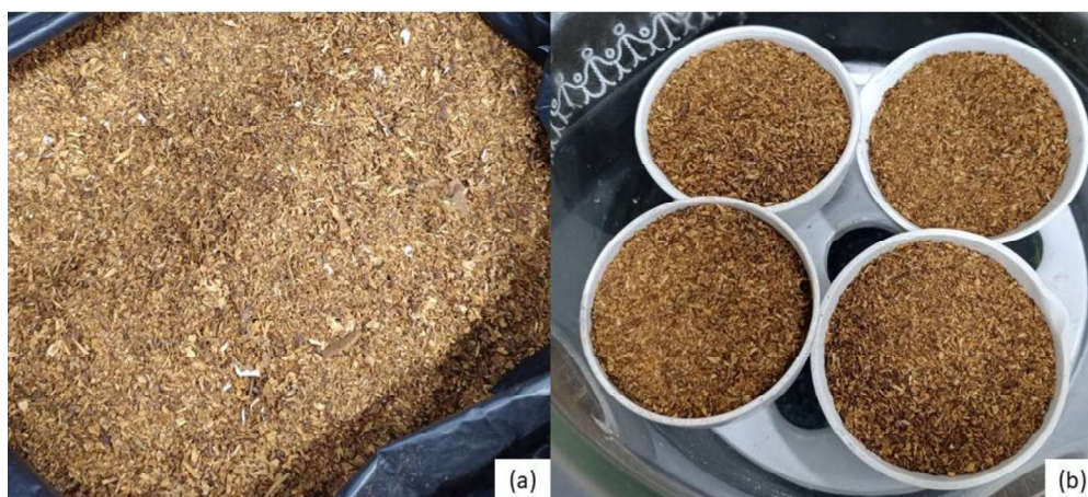
Figura 7 – (a) Tabaco no estado em que foi recebido; (b) Tabaco após peneiramento, lavagem e secagem
