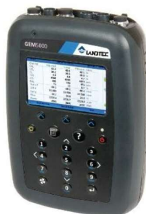
Figura 14 – Analisador utilizado para a análise da composição do gás permeado
