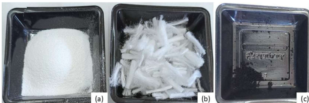
Figura 10 – Componentes utilizados no preparo das soluções poliméricas: (a) acetato de celulose; (b) fibras de acetato de celulose; (c) carvão ativado
