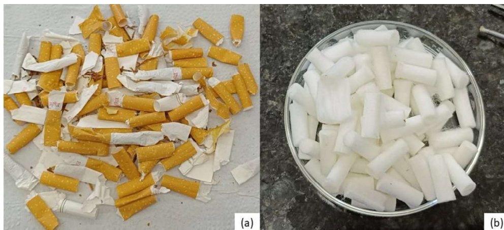
Figura 8 – (a) Filtros de cigarro no estado em que foram recebidos; (b) Filtros de acetato de celulose após separação, lavagem e secagem
