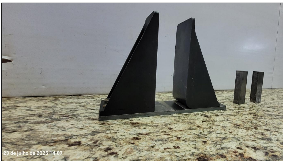
Figura 3.10: Aparato metálico utilizado no ensaio de cisalhamento por compressão
