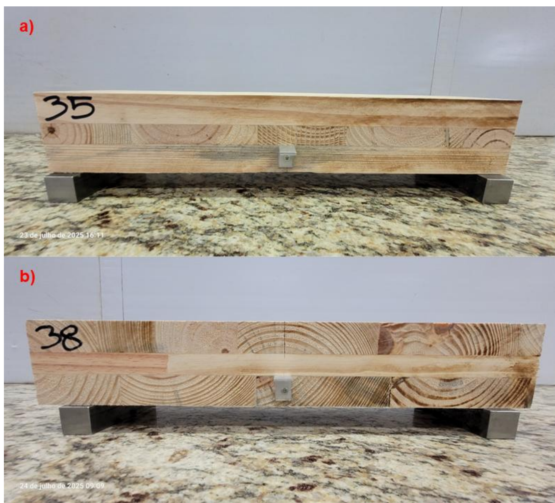
Figura 4.3: a) Corpo de prova do ensaio de flexão transversal (direção de maior desempenho); b) Corpo de prova do ensaio de flexão longitudinal (direção de menor desempenho).
