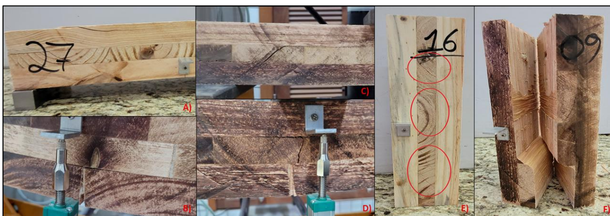
Figura 4.8: Modos de falha considerados na análise: A) Cisalhamento rolante + Flexão; B) Flexão + delaminação; C) Cisalhamento rolante puro (flexão); D) Cisalhamento rolante + delaminação; E) Cisalhamento rolante puro (compressão); F) Cisalhamento rolante + delaminação.
