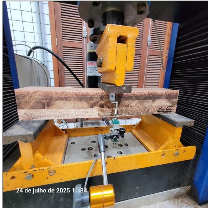
Figura 3.9: Ensaio de flexão de 3 pontos – lamela central com orientação perpendicular (Configuração transversal)
