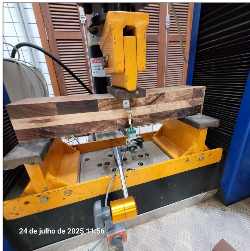
Figura 3.8: Ensaio de flexão de 3 pontos - lamela central paralela ao comprimento (Configuração longitudinal)
