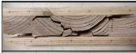
Figura 2.6: Deformação causada pelo cisalhamento rolante
