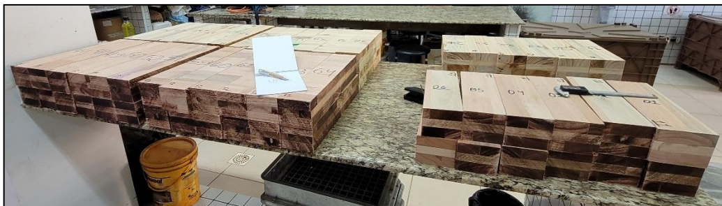
Figura 3.7: Corpos de prova aferidos, marcados e classificados.
