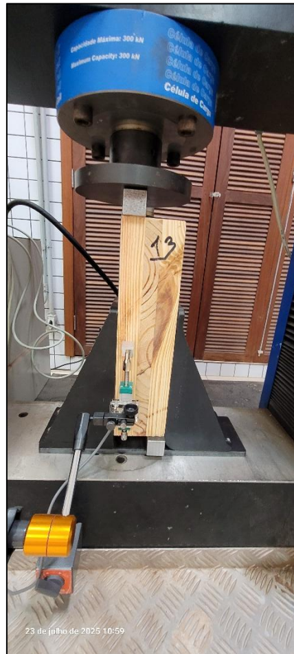
Figura 3.11: Ensaio de cisalhamento por compressão
