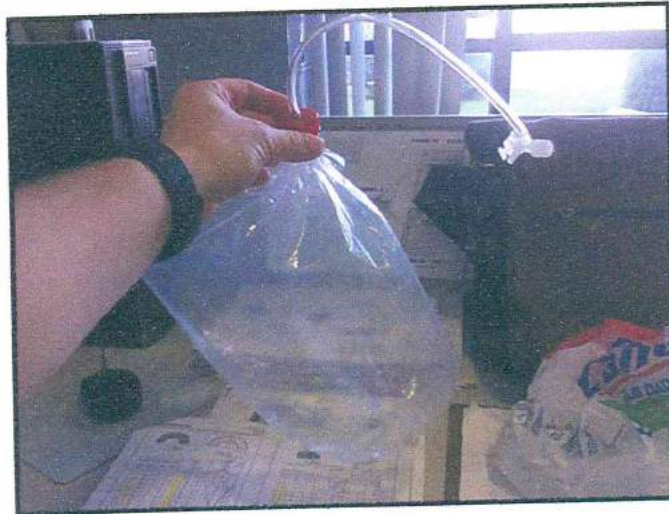
Figura 43 - Acumulo de gás em decorrência da decomposição dos resíduos de graneis sólidos coletados nas vias de acesso ao Porto.
