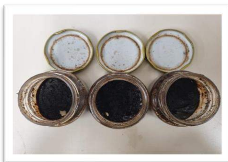
Figura 46 - Amostra após temperatura elevada no tempo t64.
